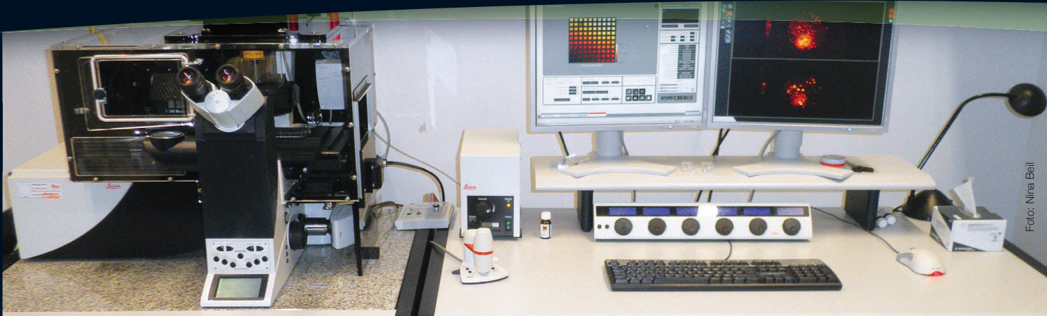
Abbildung 2b: Automatisches konfokales Mikroskop „TCS SP5“ (Quelle: Holger Erle, systembiologie.de, 06 2013, S. 47-48).
