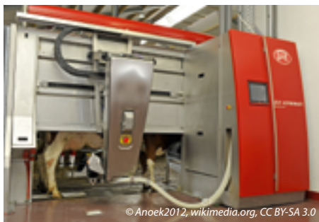
Moderne Melkroboter analysieren die Milch direkt auf ihre Qualität und auf mögliche Erkrankungen der Kuh.
